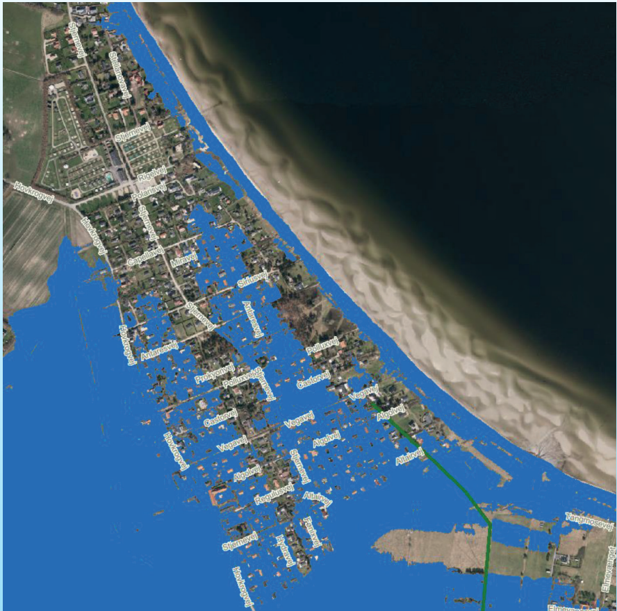
figur 2. viser området Vejlbj Fed med en havvandstand på 1,8 m. Den grønne streg viser placering af nuværende dige.(Niras notat af 2018)
